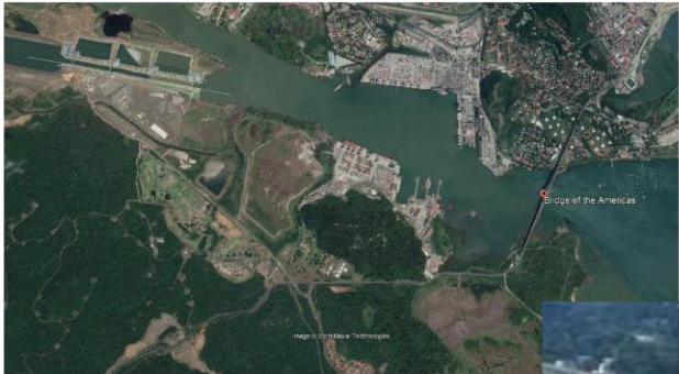
Bridge of Americas Canal do Panamá Calado aéreo máximo 62.48m
