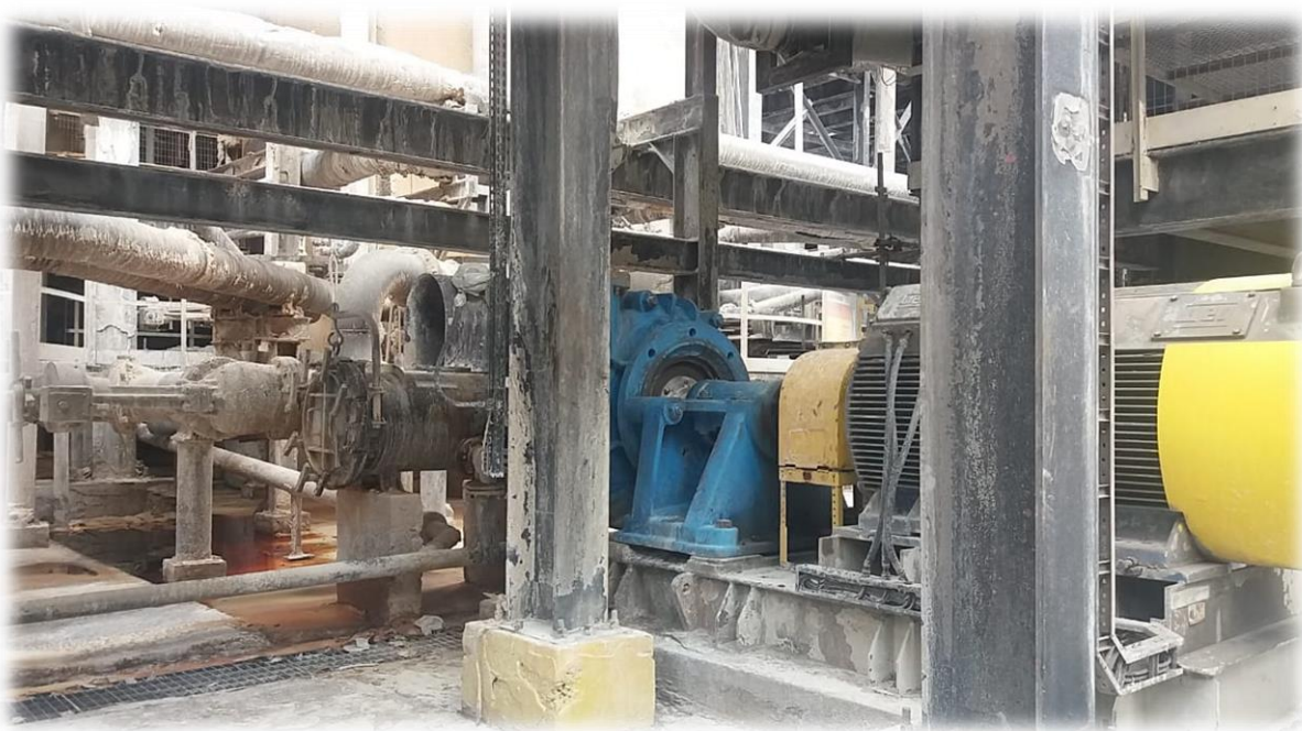
Figura 9 | Bomba da Alumina com selo mecânico para vedação.
