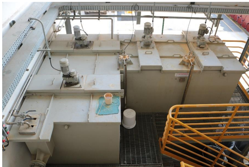
Tanque de Reação
