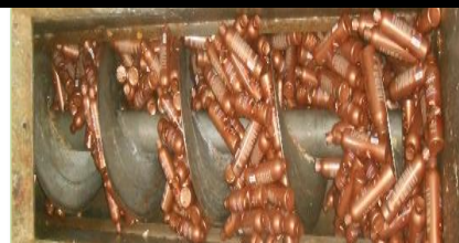
Máquina descaracteriza e separa conteúdo da embalagem plástica (sem contaminação física/bacteriológica)
