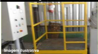
Máquina descaracteriza e separa conteúdo da embalagem plástica (sem contaminação física/bacteriológica)
