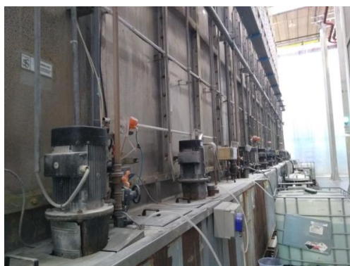
Figura 22 – Tanques de processo químico da linha de pintura vertical, aonde aplicam-se aos perfis as soluções químicas a base de titânio.
