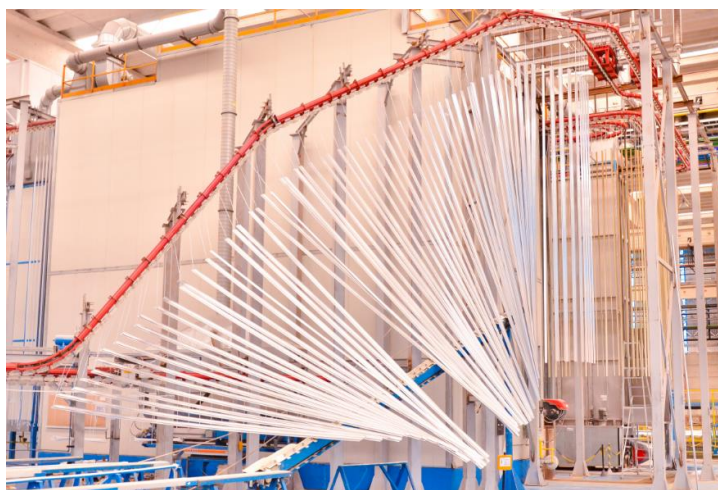
Figura 12 – Entrada dos perfis na cabine de pintura eletrostática do tratamento de superfície
