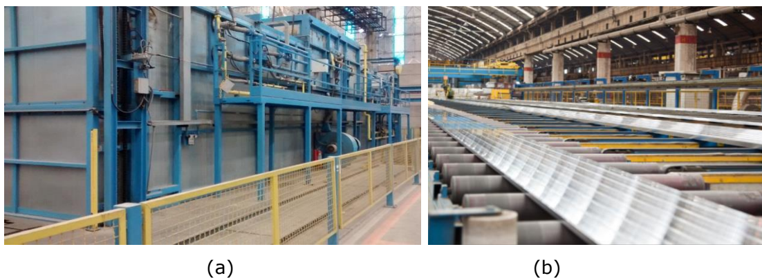
Figura 10 – (a) Forno de Aquecimento da Extrusão e (b) Material saindo da extrusora.
