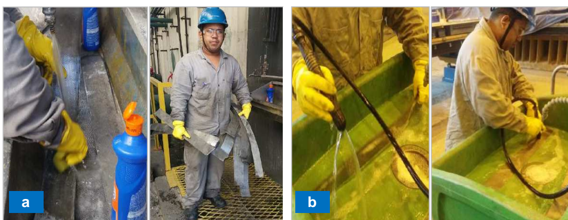
Figura 10: a) Lavagem das 800 telas com água corrente. b) Limpeza das telas com o equipamento de lavagem, similar ao utilizado para ferramentas.
