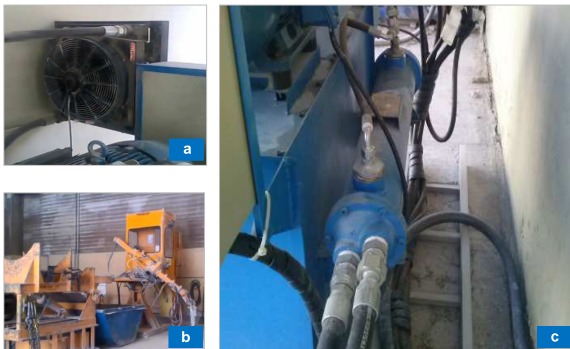
Figura 11: a) Radiadores hidráulicos com ventilação forçada. b) Máquina de limpeza de cadinhos (Maberly). c) Sistema de refrigeração com descarte de água.
