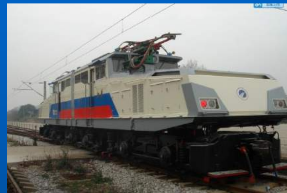
150吨斩波调速准轨电机车
