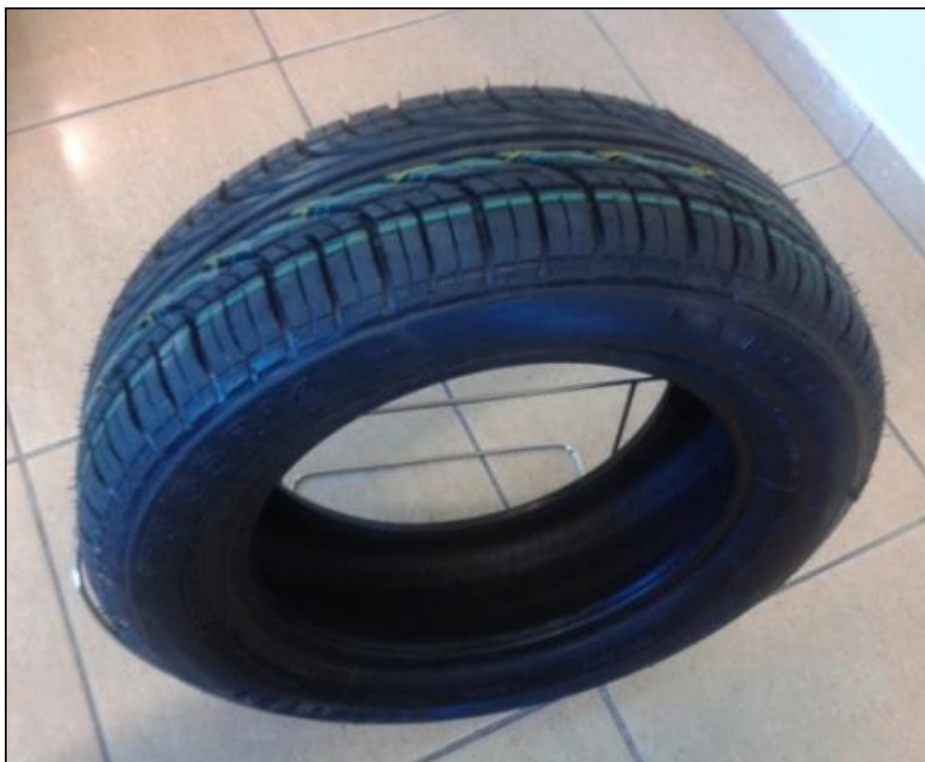
Figura 5 - Pneu recauchutado fabricado com o Negro de Fumo Ecológico produzido pela SP Pesquisa e Tecnologia Ltda, utilizando a tecnologia de orbitas.
