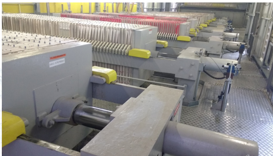
Figura 4. Filtro do tipo prensa utilizado na produção de Braspolpa®.
