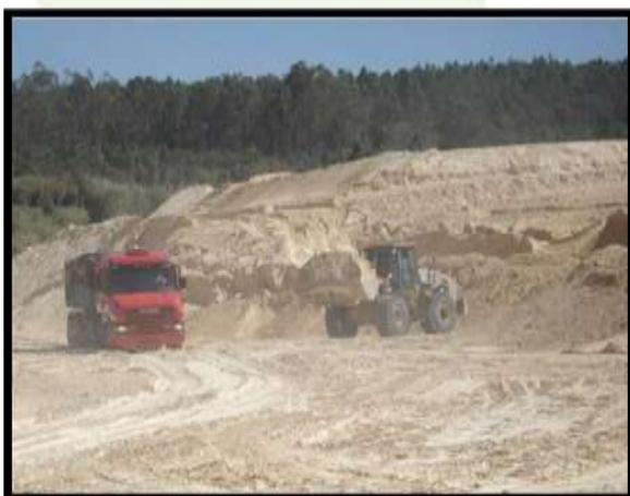
**Figura 01.** Coleta e transporte de fosfogesso a seco. **Fonte:** Matos, 2011.
