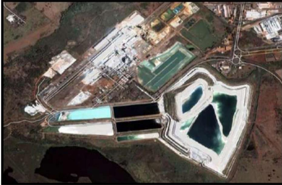
**Figura 06.** Pilhas e lagoas de sedimentação de fosfogesso em Uberaba/MG. **Fonte:** Google Earth, 2011.
