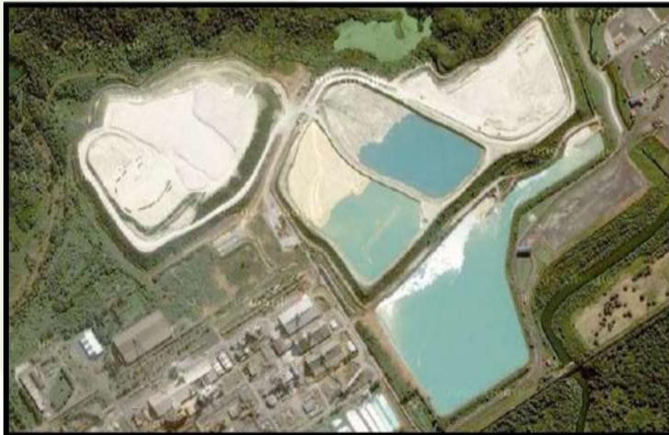
**Figura 05.** Pilhas e lagoas de sedimentação de fosfogesso em Cubatão/SP. **Fonte:** Google Earth, 2011.
