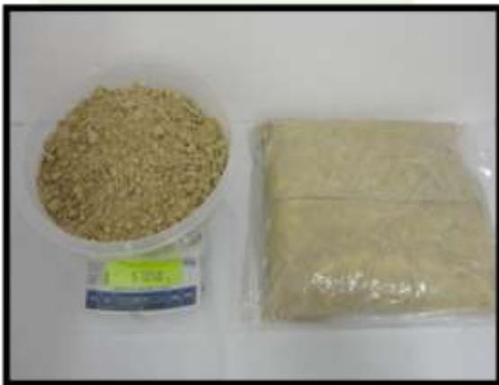
**Figura 11.** Amostras de fosfogesso bruta, conforme sai do processo.
