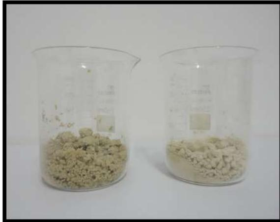
**Figura 13.** À esquerda amostra de fosfogesso úmida e à direita amostra seca.
