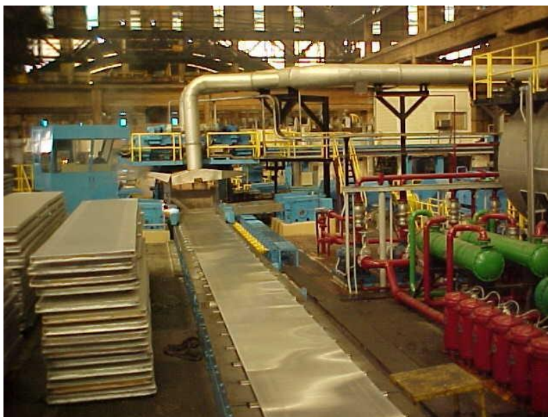
Figura 3: Exemplo de laminador à quente, no qual emprega-se uma emulsão contendo 98% de água.
