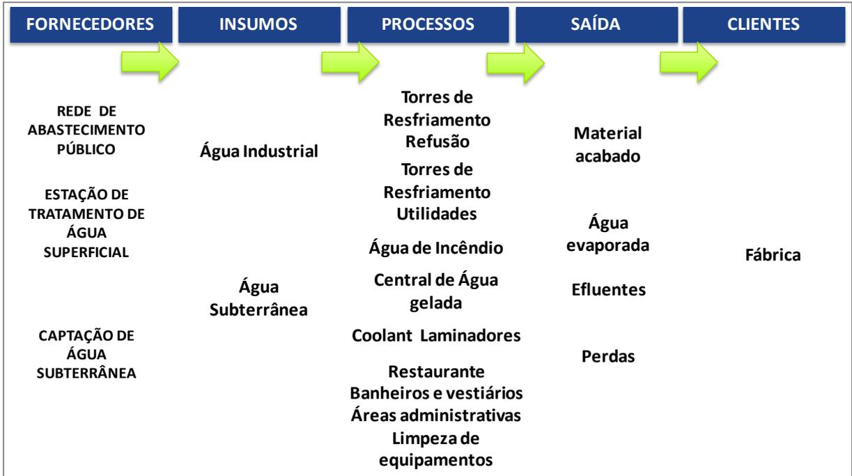
A água utilizada no processo para fabricação de laminados de alumínio na área de Refusão representa 80% do consumo da água industrial. Em relação à água subterrânea, do total consumido, 60% é direcionado para os processos de água desmineralizada na Laminação a Quente, em virtude da produção de emulsão para o coolant dos laminadores. O volume gerado de efluentes (sanitário e industrial) representa 25% do total captado.
