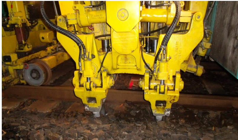
Consertos mecanizados com máquinas compactadoras
