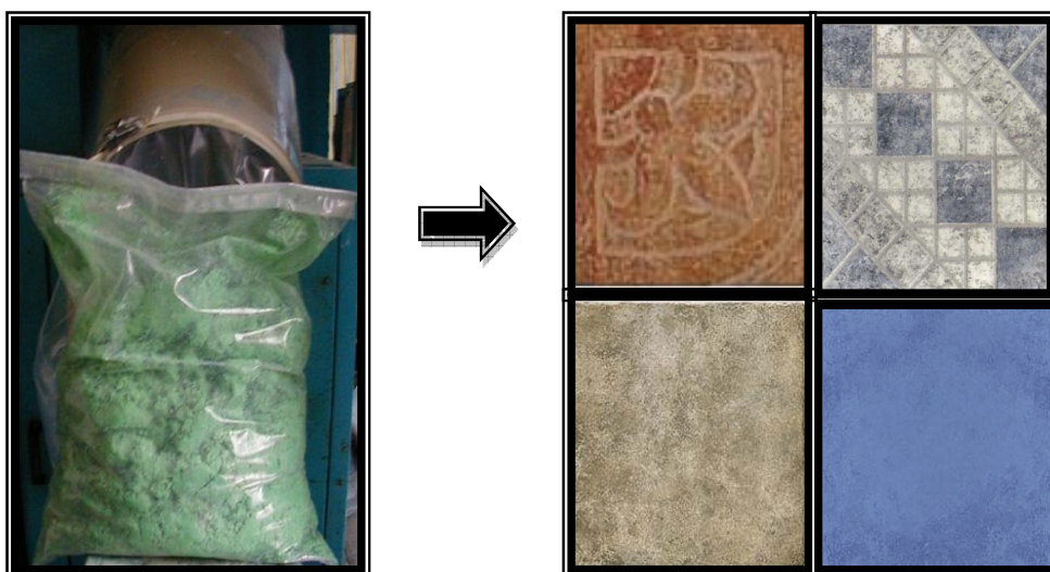
Figura 15: Lodo Galvânico e Pigmento Cerâmico
