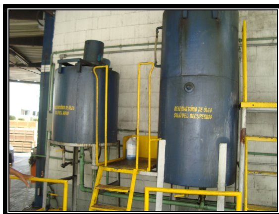
Figura 14: Reservatório de óleo separado do cavaco durante processamento.
