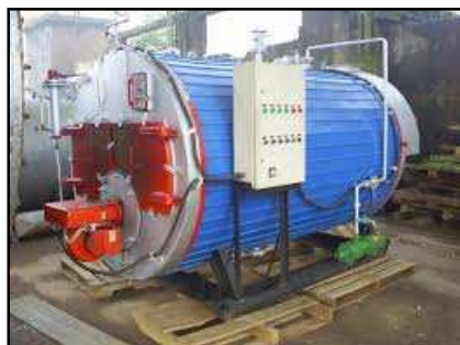
Figura 8 - Ilustração do queimador na câmara da caldeira.
