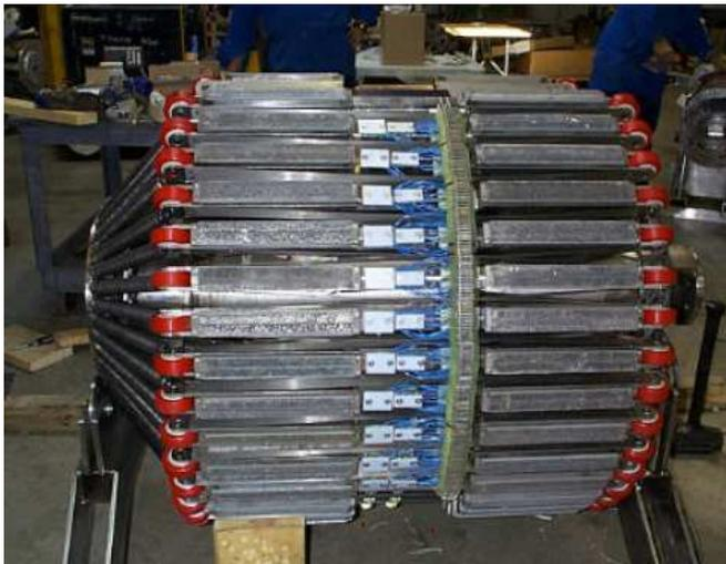
Módulo sensor do PIG instrumentado
