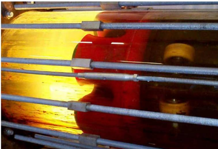
Módulo de tração do PIG em 28 in- copos deformados
