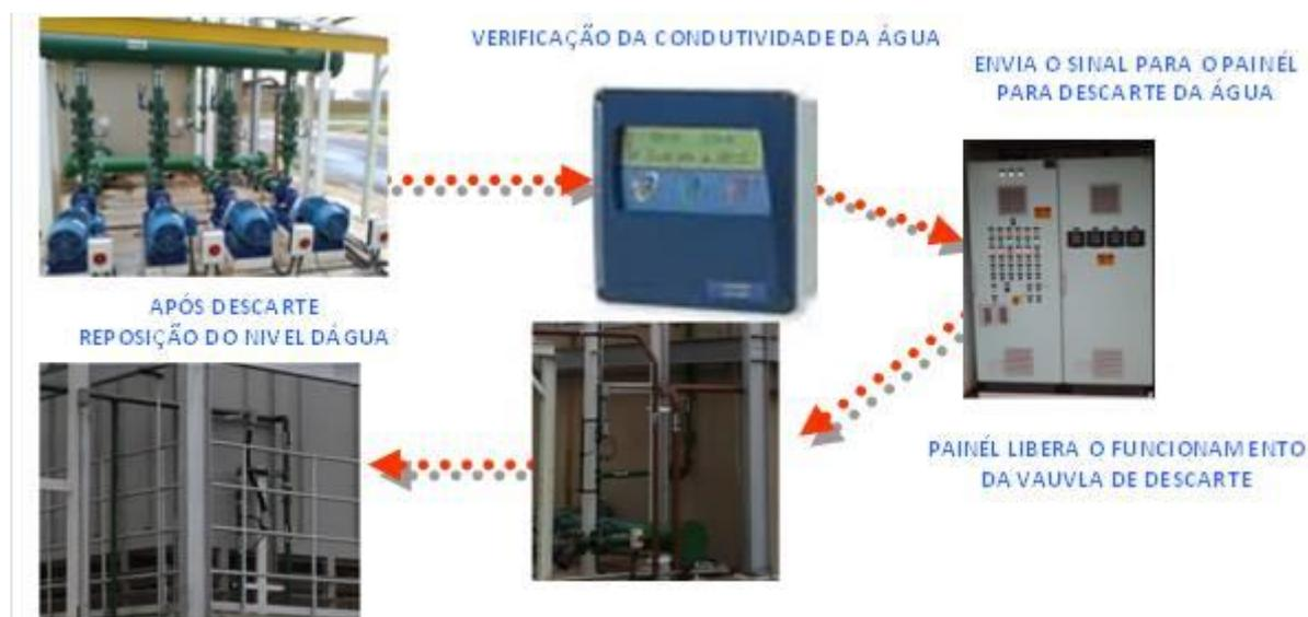
Fluxo de descarte e de reposição de água na torre de resfriamento.
