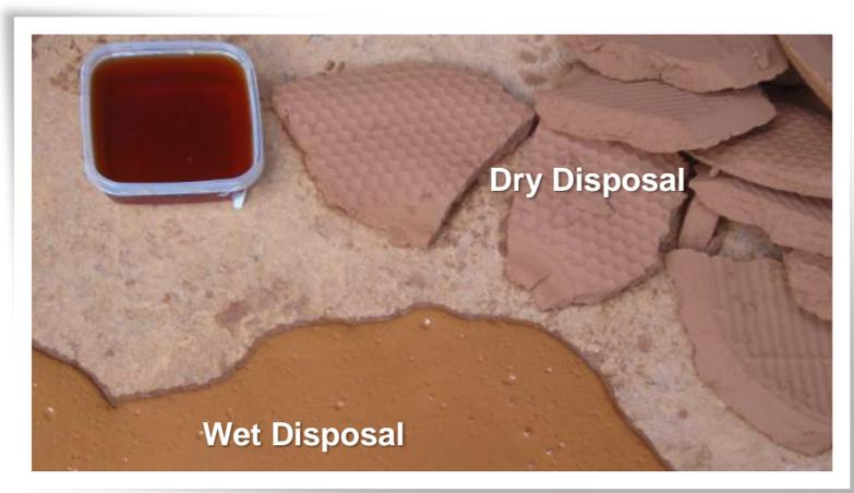
**Figura 2** – Comparação entre os resíduos de disposição úmida e seca
