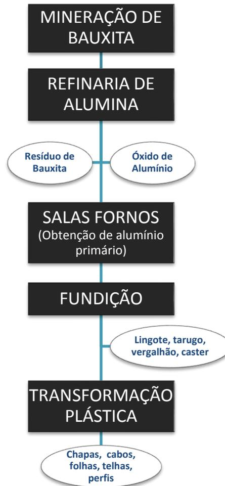
**Figura 4** – Processo integrado de fabricação de Alumínio
