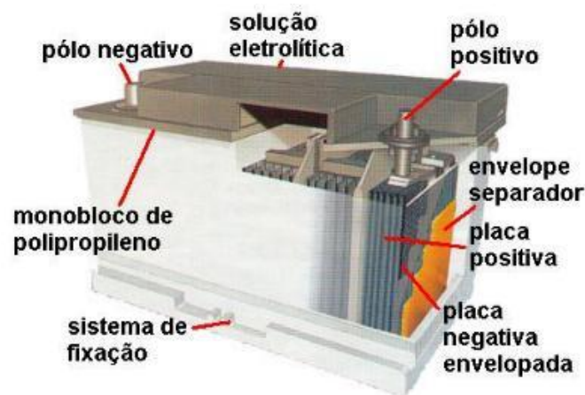
Figura 1: Componentes de uma bateria automotiva
