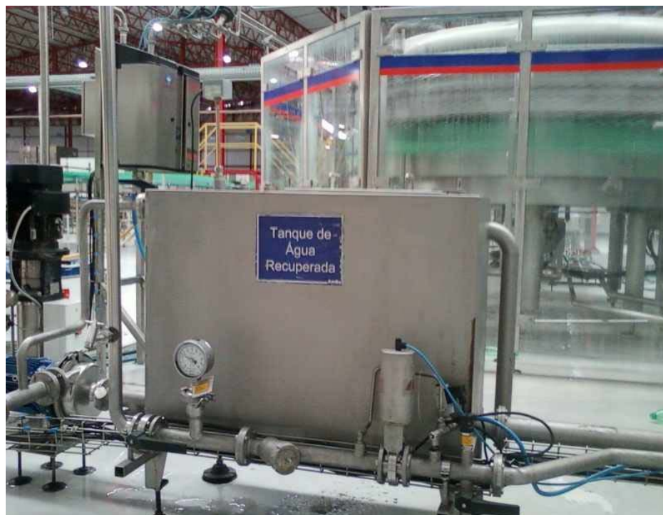
Sistema de reaproveitamento de água do rinser de Latas
