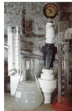
Figura 24- Instrumentos de medição instalados no Reator de trocas iônicas construído para os primeiros testes e amostra do efluente contendo Estanho
