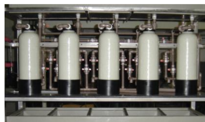
Linha de Níquel Watts – reator de troca iônica sobre o tanque lavador
