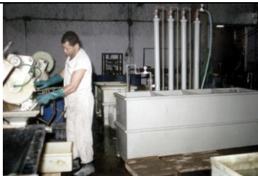
Prata Cianídrica rotativa e tanque lavador cascata com detalhes do reator de troca iônica
