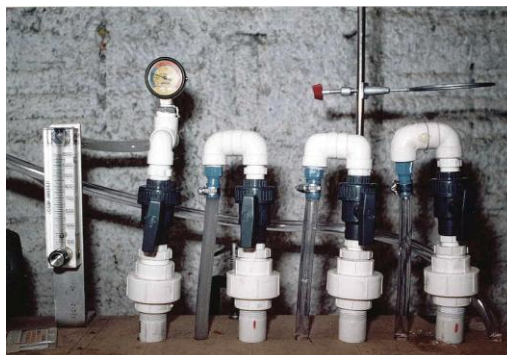
Figura 23- Detalhe do Reator de trocas iônicas construído para os primeiros testes com o Estanho
