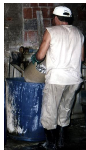
Figura 5– Lavagem após eletrodeposição metálica do Estanho na Termogal, em estágio único
