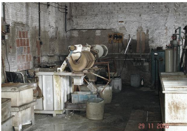
Figura 2 – Linha Rotativa Manual de Estanho, Termogal – layout atual
