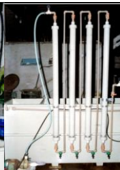
Prata Cianídrica rotativa e tanque lavador cascata com detalhes do reator de troca iônica
