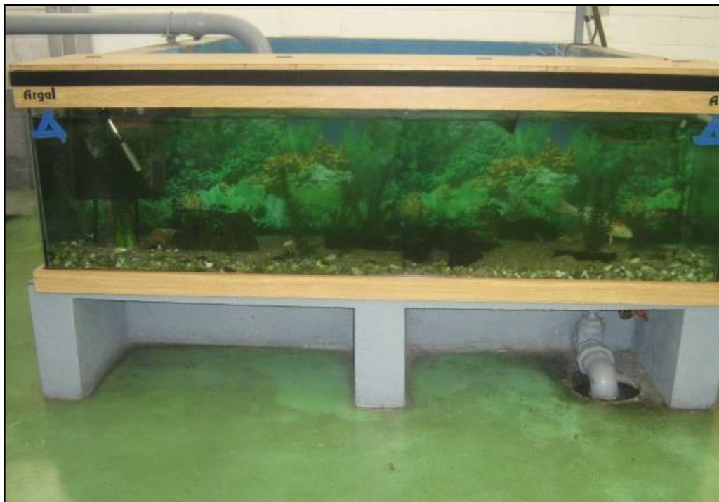
Foto 5 – Aquário utilizado no controle biológico da qualidade da água.
