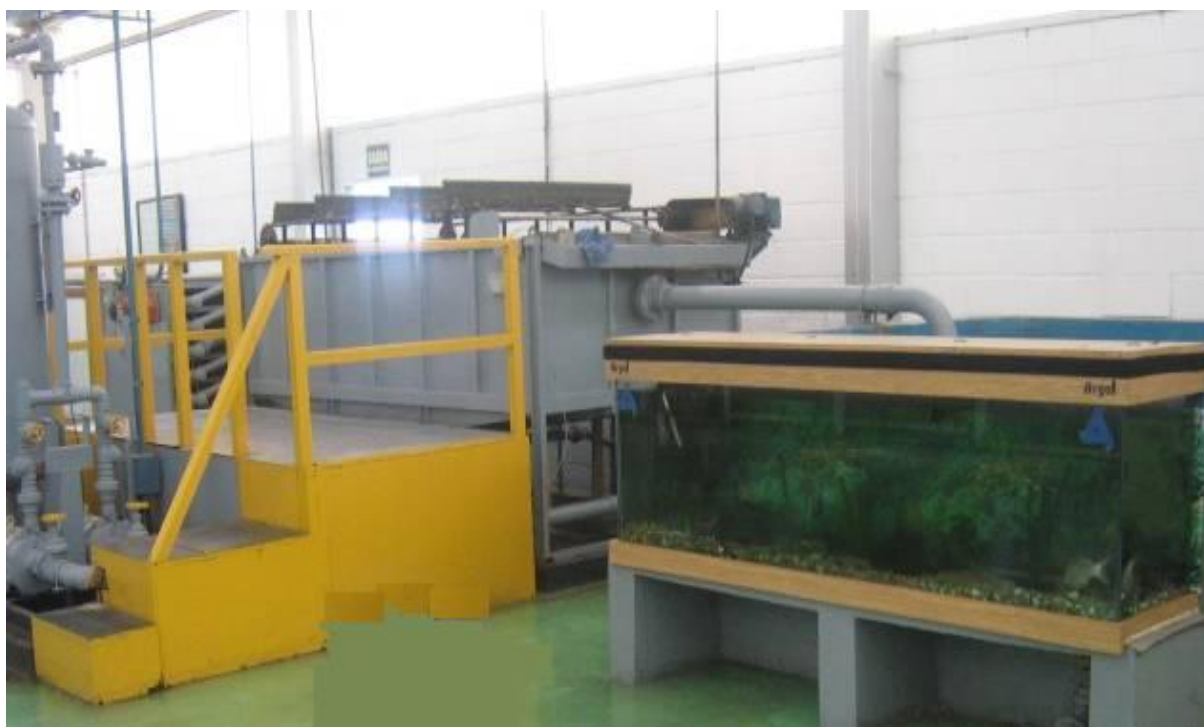
Foto 7 – Visão Geral da Estação de Tratamento de Efluente Industrial e Aquário de controle biológico da qualidade da água.
