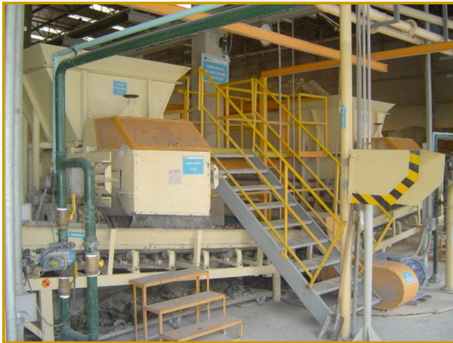
Figura 2: Dispersão dos materiais para a produção da massa cerâmica.
