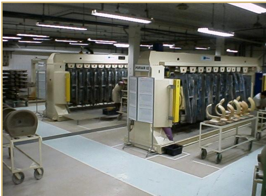
Figura 5 – Sistema em alta pressão com moldes de resina acrílica.
