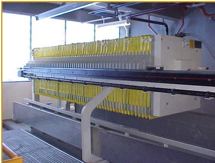
Figura 18 – Filtro-prensa.
