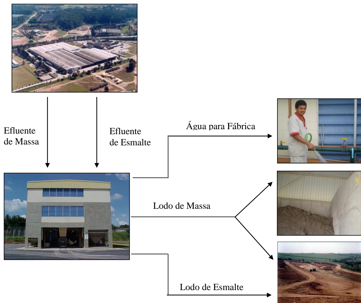
Figura 20 – Fluxo que ilustra o tratamento de efluentes realizado na ARM.
