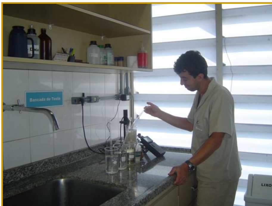
Figura 14 – Teste de bancada para definição da quantidade de produtos químicos a ser dosada em cada tratamento (batelada).
