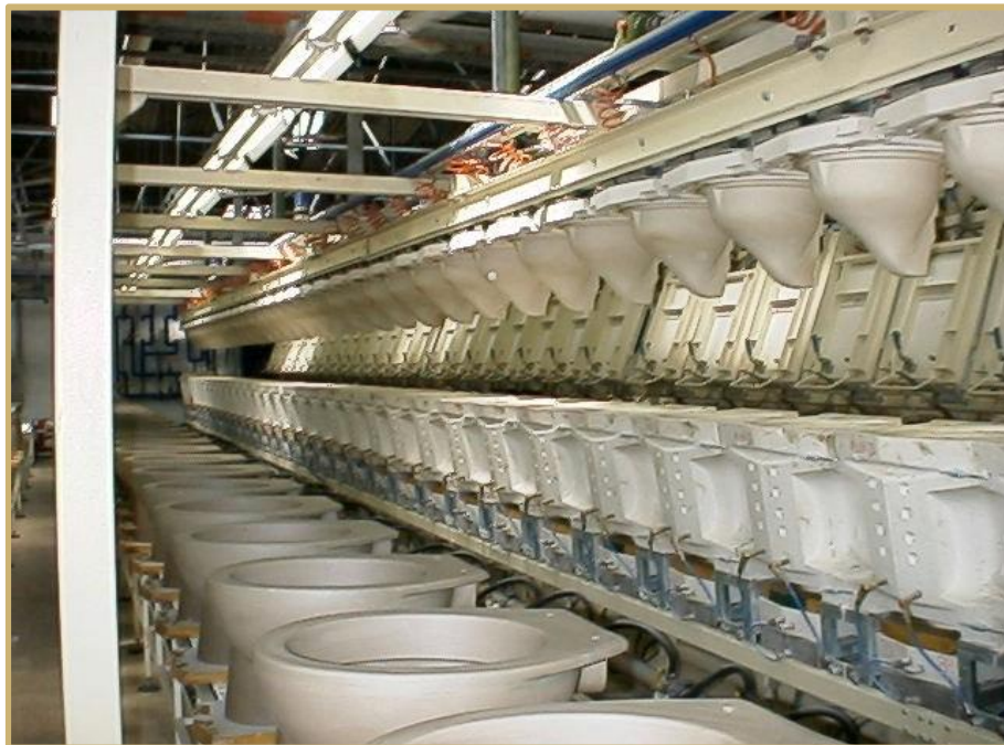
Figura 3 – Sistema mecanizado com moldes de gesso.
