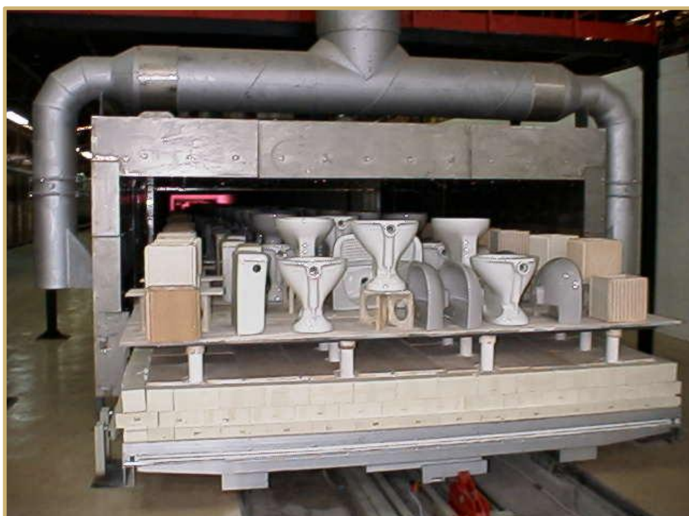
Figura 10 – Forno túnel para queima de louças sanitárias.
