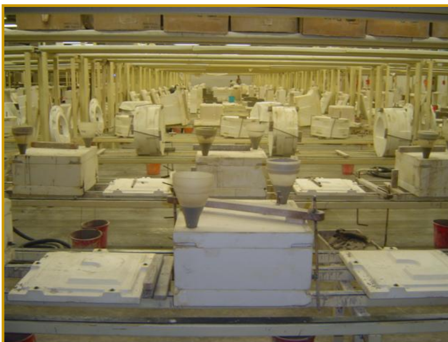
Figura 4 – Sistema convencional com moldes de gesso.
