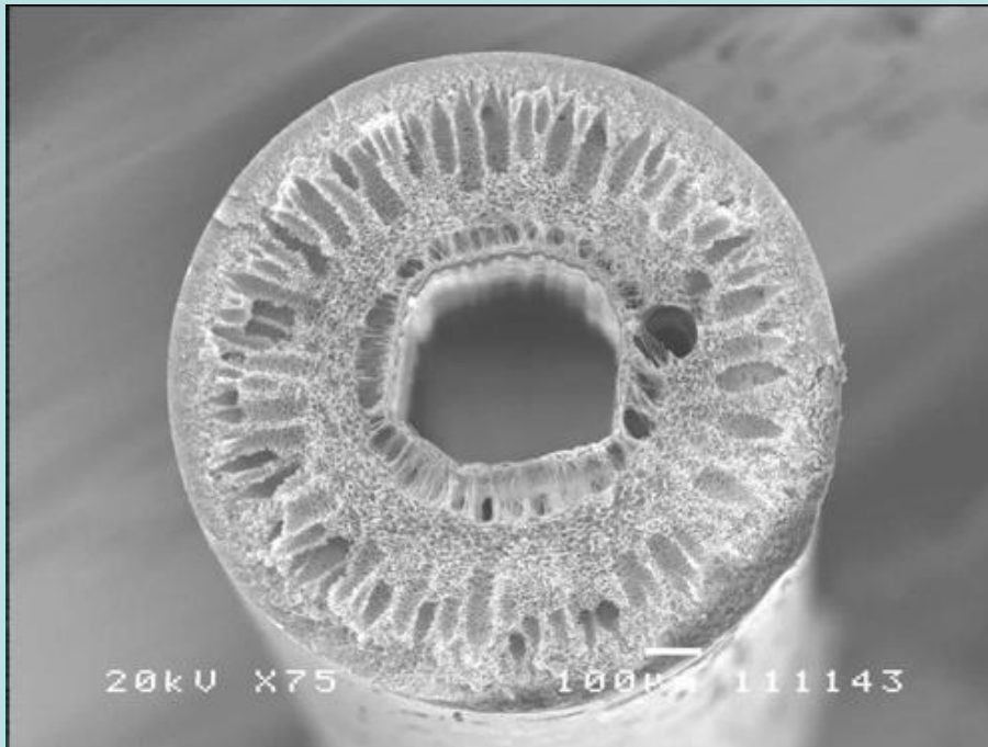
Membrana de fibra oca, seção transversal (aumento de 75 x).
