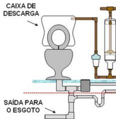
Figura 15 – Vasos sanitários instalados com descargas acopladas
