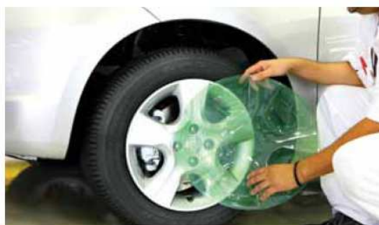
Proteção para discos de freios feitos com material reciclado de garrafas PET
