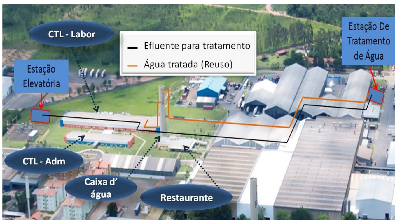
Foto 3: Foto aérea com ciclo de entrada, saída, tratamento e reuso das águas do laboratório do CTL.
