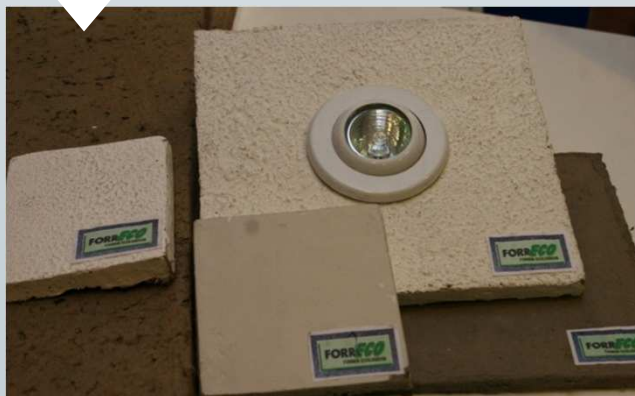
Confecção de placas de forro a partir da reciclagem de sacos de cimento vazios
