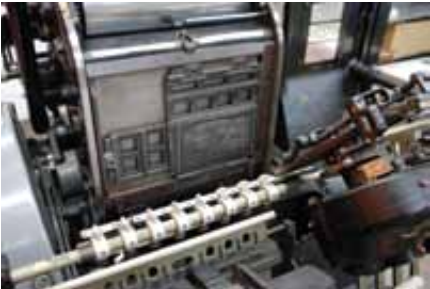
Figura 7 - Impressora tipográfica – Detalhe de uma máquina de impressão tipográfica, exibindo a fôrma de impressão, o clichê, fixo à rama através de guarnições.
