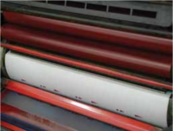
Figura 5 - Impressora offset – Detalhe dos cilindros porta-chapa e entintador de uma máquina de impressão.
