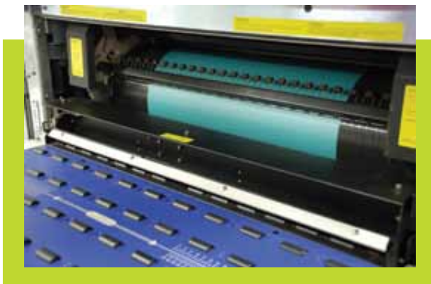
Figura 2 - Gravadora de chapas offset – Chapa para impressão offset no interior de uma máquina do sistema computer-to-plate, antes do processamento
