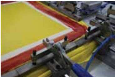
Figura 8 - Forma serigráfica – Etapa de confecção de uma tela serigráfica, quando o tecido é tensionado por meio de pinças pneumáticas e fixado ao quadro, utilizando-se um adesivo.
