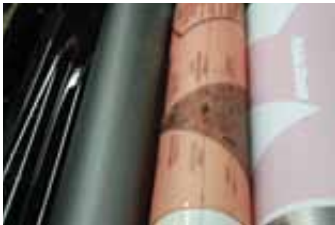
Figura 6 - Impressora flexográfica – sistema convencional (doctor-roll): detalhe de um cilindro entintador, anilox e cilindro porta-clichê de fotopolímero de uma máquina flexográfica no momento da impressão.
