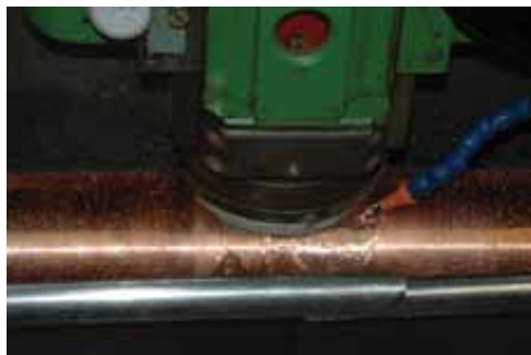
Figura 10 - Operação de polimento de um cilindro rotográfico utilizando rebolo. Nesta operação, a água utilizada é captada, tratada e reaproveitada a cada cilindro polido.
