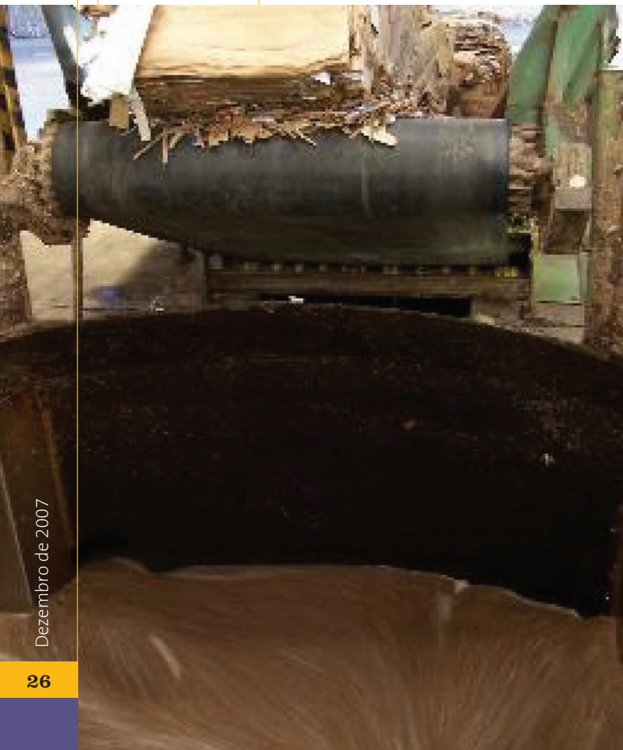
Figura 7: Entrada de fardos de aparas no hidrapulper – foto de André Souza
