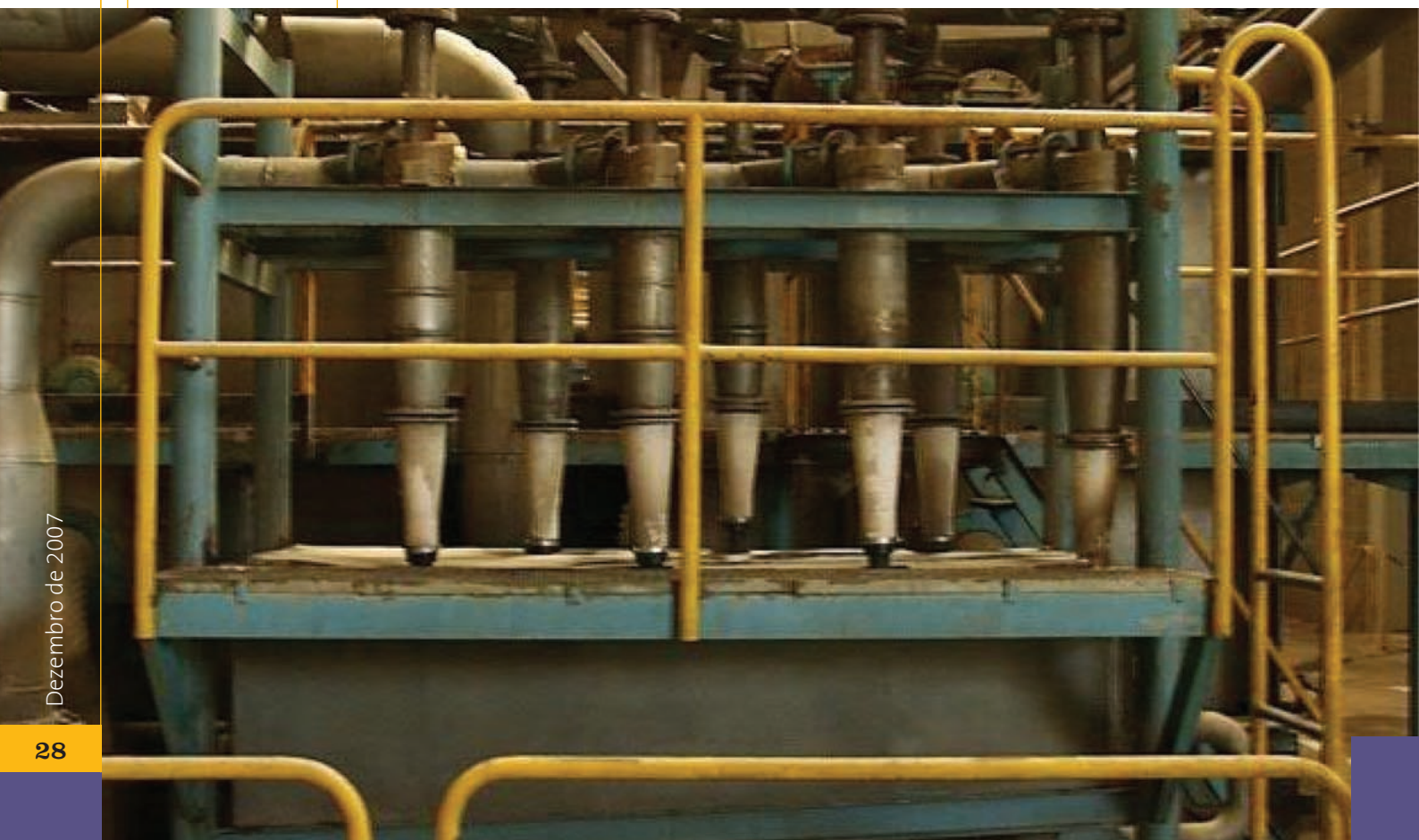
Figura 9: Vista de um equipamento de depuração fina da massa de aparas reciclada (“cleaner”) – foto de Dino Ranzani
