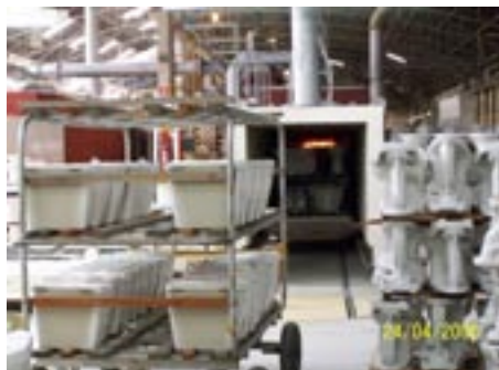
Figura 33 e 34 - saída de peças do forno
