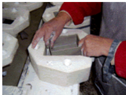
Figura 15 - colagem no molde
