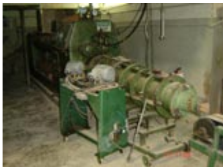
Figura 16 e 17 - Processo de extrusão de massa cerâmica
