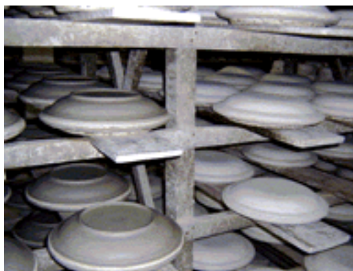
Figura 21- peças montadas para secagem
