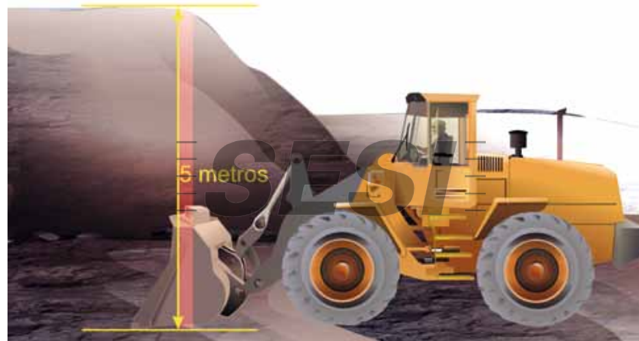
Figura 17 | Limitação da altura do barranco
