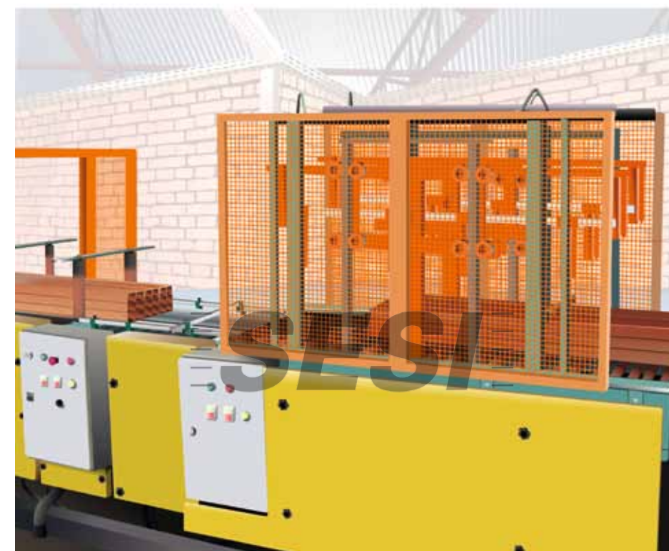
Figura 29 | Proteção para o cortador
