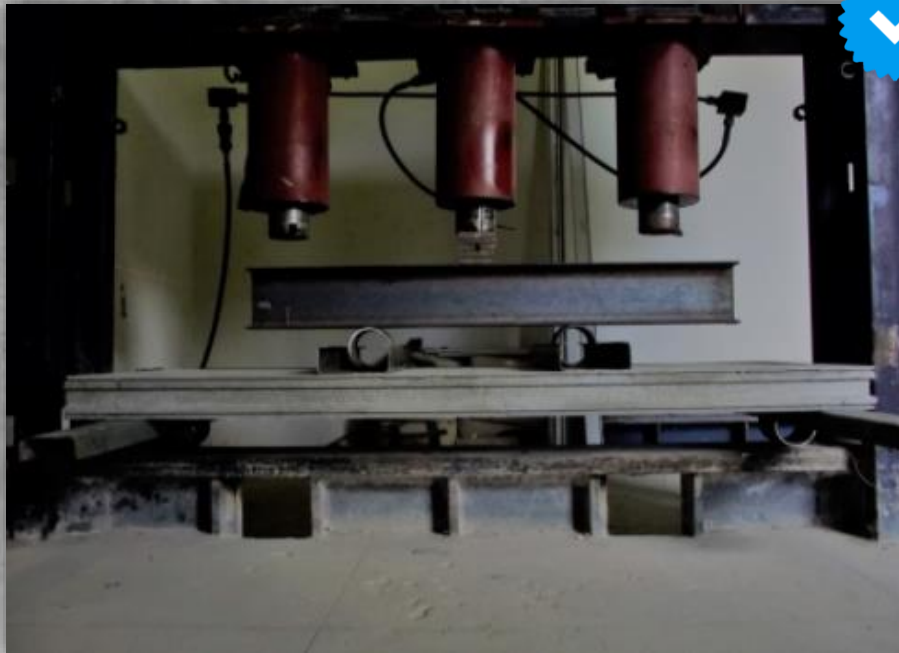
ENSAIO PARA DETERMINAÇÃO DA RESISTÊNCIA A FLEXÃO
