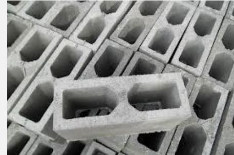
**Blocos de Concreto para Alvenaria**
